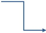
Símbolos de conexión utilizado para indicar una interconexión entre otros dos símbolos, y la dirección del flujo
